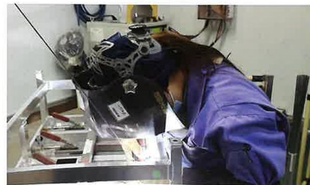
アルミ溶接。アルミは鉄より軟らかく溶けやすいため、高度な技術が必要とされる。同社は専門資格を有する技術者を数多く擁しており、同社の強みの一つとなっている
