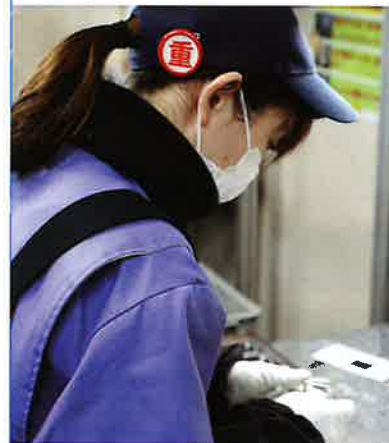
重要保安部品の検査。特別な資格を保有することを示すマークを付けた社員だけが行える重要な作業
