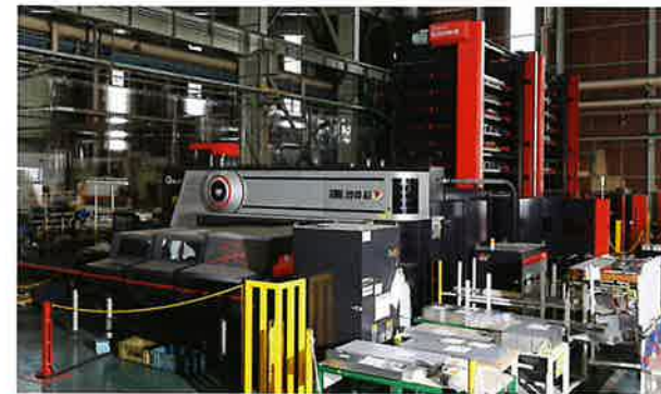
ファイバーレーザー・パンチ複合機。パンチングとレーザー加工が一気に行える
