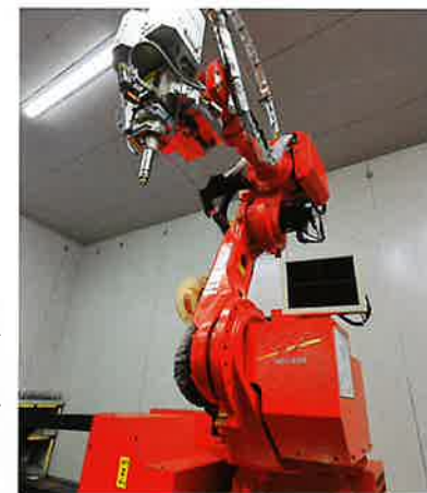
ファイバーレーザー溶接機。2020年に新規導入された設備で、高速加工により熱歪みが少なく、従来より精密な加工が可能になる
